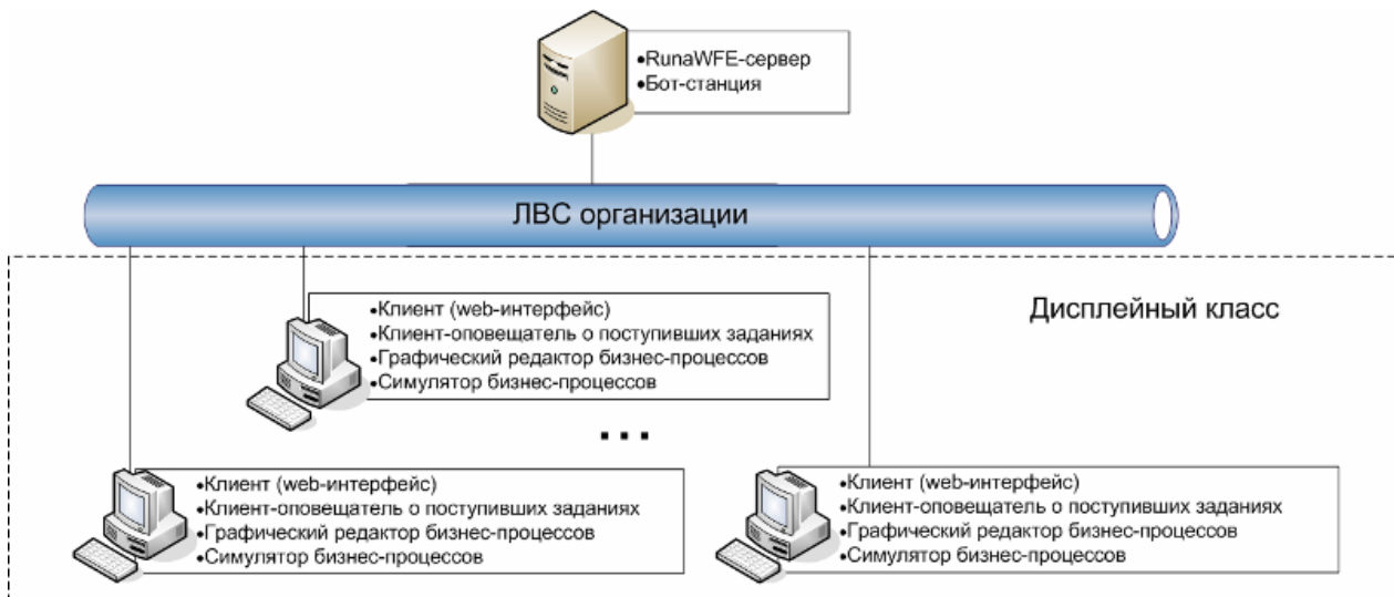
Рис 1.2 Схема взаимодействия между клиентами и сервером RunaWFE
