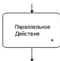
Рис. Обозначение параллельного атомарного действия без синхронизации.
