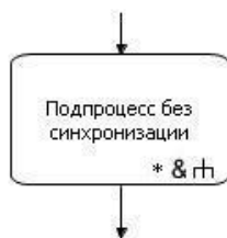
Рис. Обозначение узла – параллельного подпроцесса без синхронизации.
