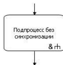
Рис. Обозначение узла – последовательного подпроцесса без синхронизации.
